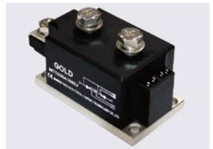
250A可控硅模块 250A Thyristor Modules 型号Type: MTC 输出耐压VRRM: 1600V 最大输出Max Load Current: 250A、300A 外形尺寸Dimensions: 115 × 50 × 52mm 安装尺寸Fixing size: 80 × 38mm, φ 6mm
