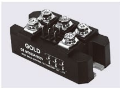
25A三相半控整流模块 250A Thyristor Modules 型号Type: MTS25A 输出耐压VRRM: 1600V 最大输出Max Load Current: 25A 外形尺寸Dimensions: 80 × 40 × 27mm 安装尺寸Fixing size: 66mm, φ 6.5mm
