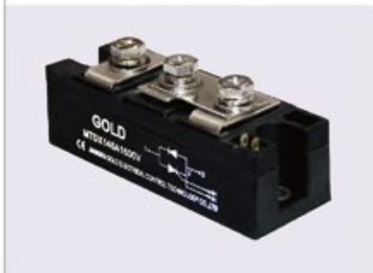
140A可控整流桥模块 140A Controllable Rectifier Module 型号Type: MTDX140A 输出耐压VRRM: 1600V 最大输出Max Load Current: 140A 外形尺寸Dimensions: 94 × 34 × 29mm 安装尺寸Fixing size: 80mm, φ 6.3mm
