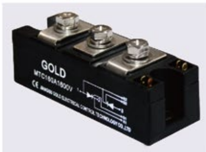
130A 可控硅模块 130A Thyristor Modules 型号Type: MTC 输出耐压VRRM: 1600V 最大输出Max Load Current: 130A、160A 外形尺寸Dimensions: 94 × 34 × 29mm 安装尺寸Fixing size: 80mm, φ 6mm
