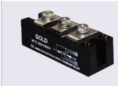
160A可控硅模块 160A Thyristor Modules 型号Type: MTC 输出耐压VRRM: 1600V 最大输出Max Load Current: 160A、200A 外形尺寸Dimensions: 95 × 34 × 29mm 安装尺寸Fixing size: 80mm, φ 7mm
