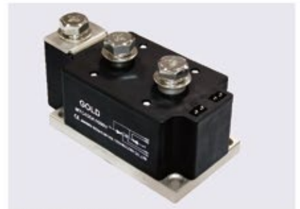
400A可控硅模块 400A Thyristor Modules 型号Type: MTC 输出耐压VRRM: 1600V 最大输出Max Load Current: 400A、500A 外形尺寸Dimensions: 150 × 60 × 54mm 安装尺寸Fixing size: 112*48mm, φ 6mm
