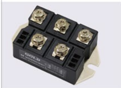
155A三相整流桥模块 155A Three-phase Rectifier Bridges Module 型号type: MDS 输出耐压VRRM: 1600V 最大输出Max Load Current: 155A、200A 外形尺寸Dimensions: 94 × 53.7 × 30mm 安装尺寸Fixing size: 80mm, φ 6.5mm
